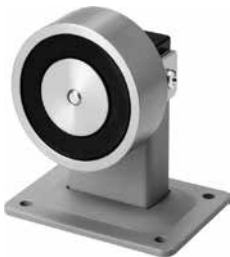
Magnet Modell 830 BWK/U Haftmagnete mit Distanzhalter. Für Boden- und Wandmontage umbaubar wahlweise mit Unterbrechertaste
